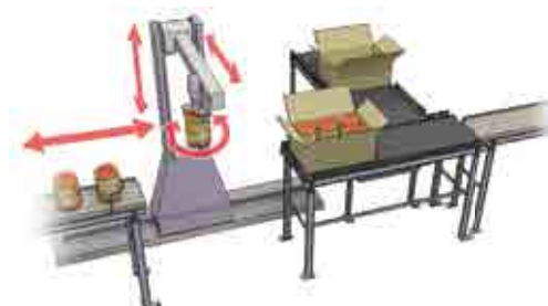
[使用內置定位的裝箱裝置示例]
