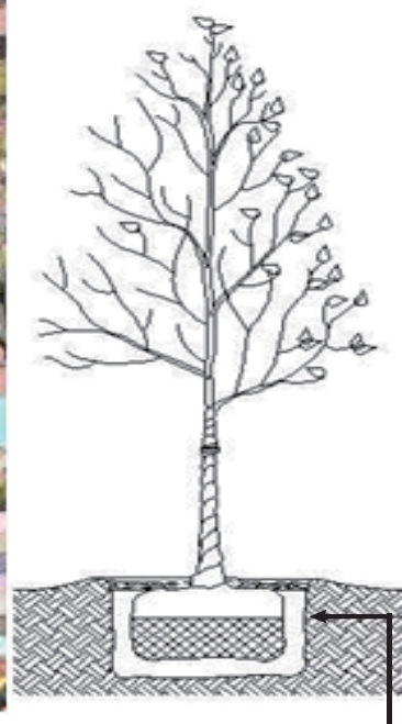
土壤太硬加上黏粒層太高形成排水不良
