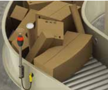
使用對照式的感測器以檢測輸送帶有無堆料情形
