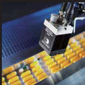
檢測不正確的他色膠囊包裝置入
