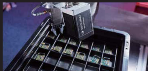
VISOR® Robotic視覺可同時偵測最多達255個的零件定位
