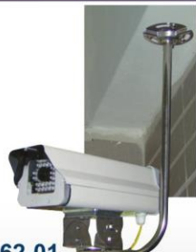
62-01 MODEL：吸頂式固定架 (L型) 材質：不銹鋼 厚度：支架1.5mm / 固定座2mm 高度：40cm或30cm 可承載60kg，其他尺寸可訂製
