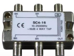
04-09 MODEL : SC4-16 四路分岐器 頻率範圍 : 10-2500MHz TAP : 12,16,20,24,28 dB
