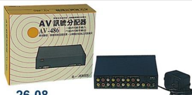
26-08 MODEL : AV-486 A/V訊號分配器1入6出 一組A/V端子輸入，六組A/V端輸出具有聲音、 影像信號加強效果，以補償分配後之信號損失 參考規格：頻率範圍:20HZ~10MHZ 插入損失：AUDIO 20~20KHZ 1dB / VIDEO 0.5~10MHZ 1dB 隔離度：30dB以上 電 源：120VAC/15VDC 300mA直流轉換器
