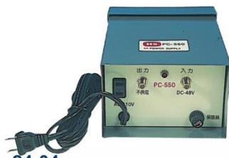
24-04 MODEL : DC-3A / DC-5A 輸入電壓範圍: 110V±10% / 220V±10% 輸入電壓頻率: 60HZ / 50HZ 輸入電壓波形: 正弦波 輸出電壓: DC48V±2V 供電效率: ≥85% 短路保護: 短路排除後,自動恢復供電。
