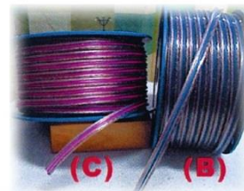
49-03 MODEL : SPK-336TC(藍、粉) 結構 : (48 / 0.11*4+48 / 0.11*3)*2F OD : 5.0*14.3mm 材質 : 混合絞 長度 : 50Y 適用於 : 發燒、便利
