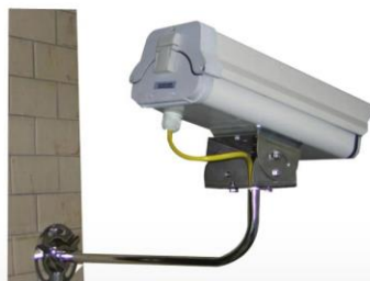
62-02 MODEL：牆壁專用固定架 材質：不銹鋼 厚度：支架1.5mm / 固定座2mm 可承載20kg，其他尺寸可訂製
