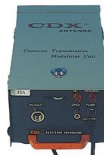
24-05 MODEL : AC-12A交流電源供應器 輸入電壓: AC90V~125V RMS 輸入頻率: 60HZ / 50HZ 輸出電壓: 60V RMS / 90V RMS 輸出電流: 3.5A、7A、12A、15A 工作溫度: 攝氏5度~55度 適用範圍: 有線電視電源供應器
