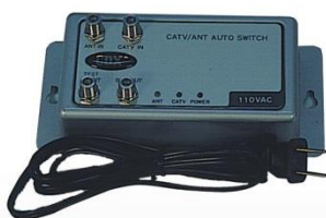
18-05 大樓自動切換 適當入力 : 65~80 dB 入力頻率 : 5~900MHz 隔離度 : 60 dB 插入損失 : CATV 1.5 dB 動作準位 : 50 ±2dB 平坦度 : 5~900MHz±0.5 dB 電源電壓 : AC-110V
