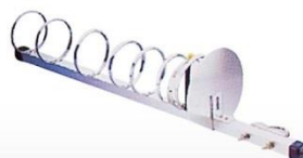
56-14 MODEL : YA-1215 指向性天線 頻率 : 1.2GHz 尺寸 : 65cm 增益 : 15db 重量 : 600g 接頭 : SMA形式
