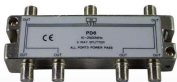
04-04 MODEL : PD6 六路分配器 頻率範圍 : 5-2500MHz 插入損失 : 16dB
