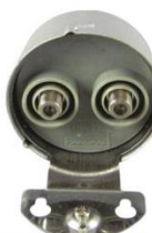
18-08 MODEL : OM-77有線電視專用避雷器 頻率範圍 : 10~780MHz Frequency Response 平坦度 : ±0.3 dB 絕緣抵抗 : DC500V Insulation Resistance 1.5Mohm Frequency Response 駐波比 : 1.2-1.5 反射損失 : -16dB V.S.W.R Return Loss 插入損失 : 0.6dB
