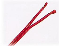
48-10 MODEL : SPK-150C 結構 : (23 / 0.11*3)*2F OD : 3.4*6.8mm 材質 : LC-OFC 長度 : 80M 適用於 : 喇叭線
