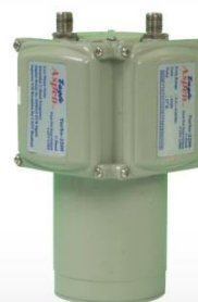
02-09 C頻雙輸出集波器 頻率範圍：4-4.2GHZ Gain: 65dB Noise : 17° K
