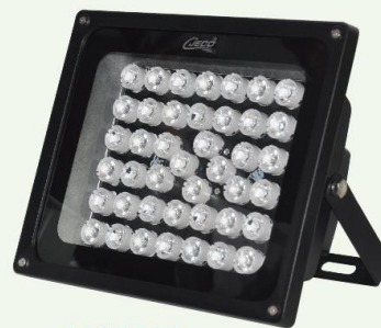
CJ-H4815 1. 高功率 鋁基板陶瓷LED*48顆 2. 投射距離: 300米(15度) 3. 可搭配攝影機之外部控制接點 4. 電源輸入: DC12V/8A 5. 防水級數: IP66 6. 適用場景: 路口監控、廠房專用 7. 尺寸: 高24 寬29 深15
