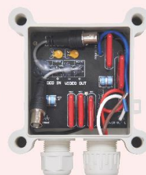
雙工避雷器(1組訊號+1組電源)
