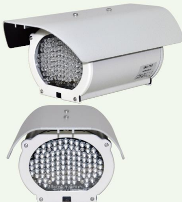
CJ-IRL 707 100顆5Φ高效能LED 投射距離: 50-100M 尺寸: 長220mm*寬150mm*高125mm
