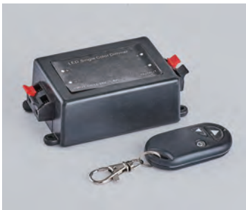
品名：遙控條燈專用調光器 規格：DC12V / 8安培 / 96W 尺寸：L:108mm W:58mm H:33mm
