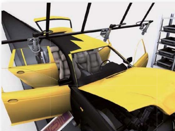
超聲波檢測透明車窗，不受表面顏色影響，其他座椅、車頂位置、升降等控制
