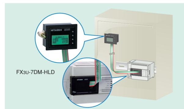
盤面扉などへの取り付けにより、扉等を開けることなくデバイスのモニタ/テスト操作や表示画面を確認できます。
