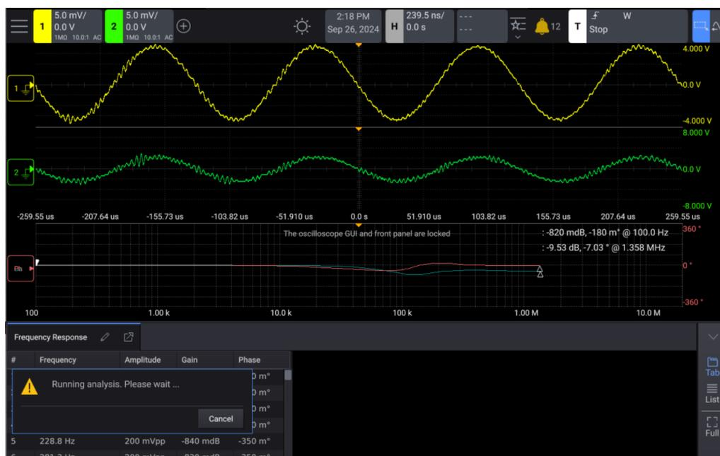
注意：如果測試結果出現負值，需要在通道設置中切換一下輸入輸出通道設定。
