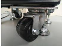
水平止柱、可調整固定座
